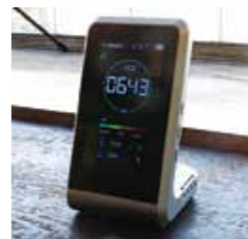
常時室内を清浄な空気の維持コントロールが測定できる装置
