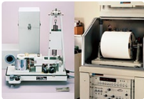
被災状況の予測には地震計が必要
