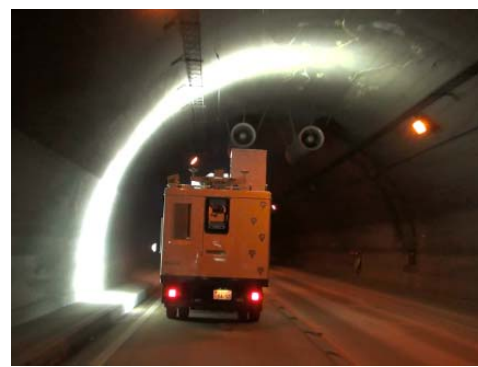
走行型高速 3D トンネル点検システム
