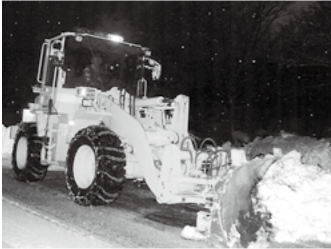
深夜の除雪作業
