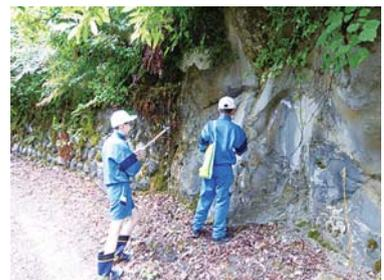
学校から犀川、大岡道の駅、そして新町の左右地区から美麻大塩へ抜ける道沿いの露頭を調査しながら、目の前の崖の地層のようすや傾斜を記録し、青木層と小川層の重なり方について推測しながら、手作り地質図を完成させました。
